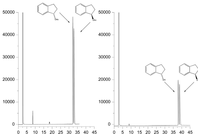
Fig. 2. GC chromatograms of rac -indanyl acetate t_R 32.68 min. (S) t_R 33.17 min. (R) and rac -indanol t_R 37.95 min. (S) t_R 38.98 min. (R).
