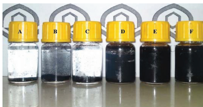
Fig. 5. Dispersibility of CNTs: (A) MWCNTs (CH 3 NO 2 ), (B) MWCNTs-COOH (CH 3 NO 2 ), (C) MWCNTs-SO 3 H ( n -hexane), (D) MWCNTs-SO 3 H (H 2 O), (E) MWCNTs-SO 3 H (CH 3 CN), and (F) MWCNTs-SO 3 H (CH 3 NO 2 ).
