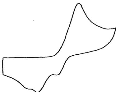
Fig. 3. Cyclisches Voltammogramm von COT in THF. Leitsalz:  $[\text{N}(\text{CH}_3)_4][\text{Al}(\text{C}_2\text{H}_5)_4]$ ,  $10^{-1}$  mol. Depolarisator: COT,  $6 \cdot 10^{-3}$  mol. Pt-Elektrode. Abfahrsgeschwindigkeit:  $50 \text{ V} \cdot \text{sec}^{-1}$ .
