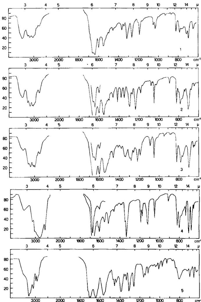
Fig. 2. IR.-Absorptionsspektren in KBr (PERKIN-ELMER Zweistrahl-Spektrograph Modell 21)
