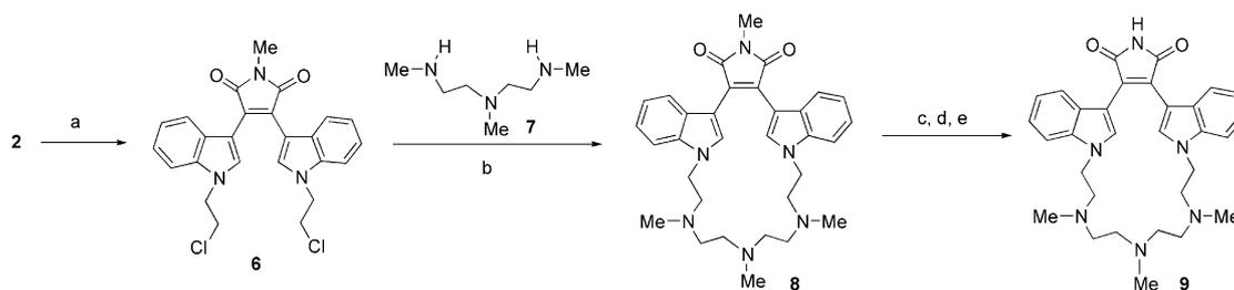
**Scheme 2.** (a)  $\text{ClCH}_2\text{CH}_2\text{Br}$  (excess),  $\text{Cs}_2\text{CO}_3$ , DMF,  $45^\circ\text{C}$ ; (b)  $\text{KI}$ ,  $i\text{-Pr}_2\text{NEt}$ , THF,  $120^\circ\text{C}$ ; (c)  $\text{KOH}$ , EtOH,  $80^\circ\text{C}$ ; (d) citric acid,  $\text{H}_2\text{O}$ ; (e) neat  $\text{NH}_4\text{OAc}$ ,  $140^\circ\text{C}$ , 41% overall from **2**.
