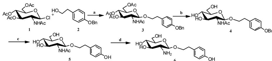
Reagents: a)  $ZnCl_2$ , DMT·Cl,  $CH_2Cl_2$ ; b) NaOMe, MeOH, rt, 3 h; c)  $HCOONH_4$ , 5% Pd/C,  $CH_3OH$ , reflux; d) 30% KOH, EtOH.
