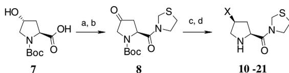
**Scheme 1.** Reagents: (a) thiazolidine, HOBT, EDC, DMF; (b) DMSO, SO<sub>3</sub>-pyridine complex; (c) amine X, NaBH(OAc)<sub>3</sub>, AcOH, 1,2-dichloroethane; (d) H<sup>+</sup>.
