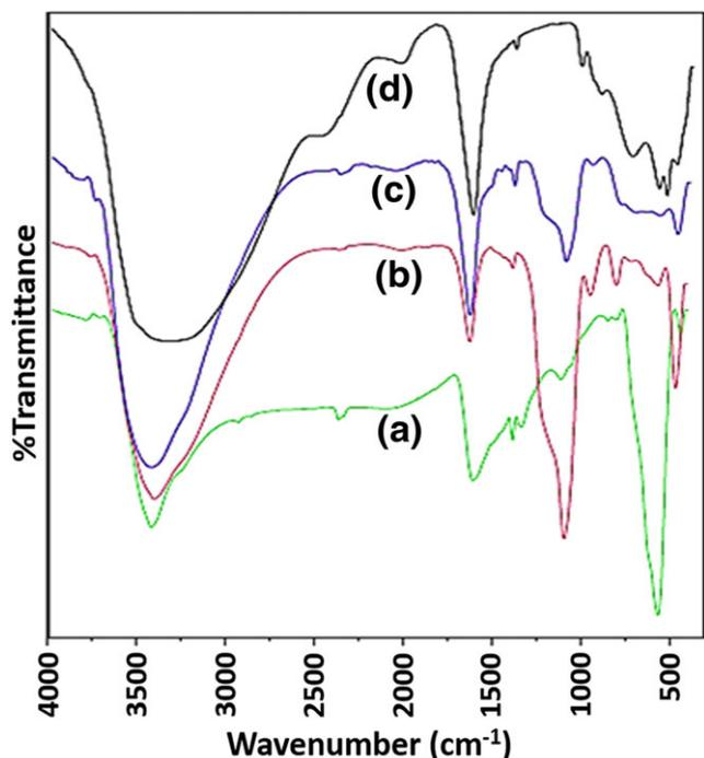
**FIGURE 1** FT-IR spectra of (a)  $\text{Fe}_3\text{O}_4$ -MNPs and (b)  $\text{Fe}_3\text{O}_4@$  $\text{SiO}_2$ -MNPs (c)  $\text{Fe}_3\text{O}_4@$  $\text{SiO}_2$ - $\text{ZrCl}_2$ -MNPs (d)  $\text{ZrCl}_4$
