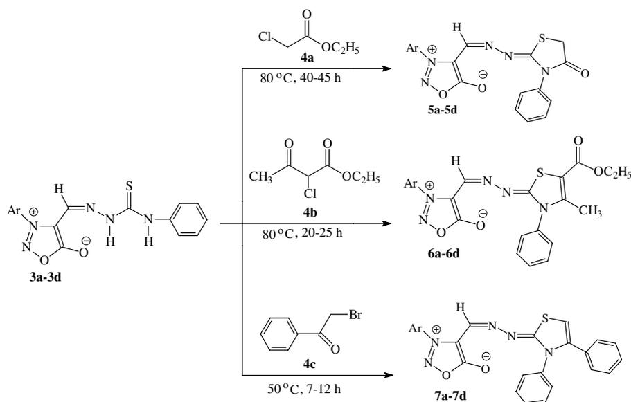
Scheme 2. **3a**: Ar=C<sub>6</sub>H<sub>5</sub>; **3b**: Ar=*p*-CH<sub>3</sub>C<sub>6</sub>H<sub>4</sub>; **3c**: Ar=*p*-CH<sub>3</sub>OC<sub>6</sub>H<sub>4</sub>; **3d**: Ar=*p*-C<sub>2</sub>H<sub>5</sub>OC<sub>6</sub>H<sub>4</sub>.
