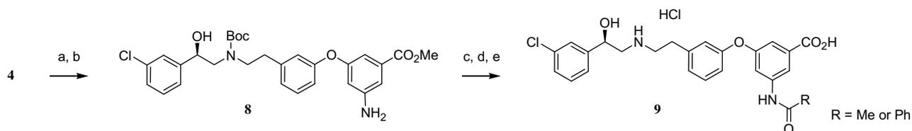
**Scheme 2.** Reagents: (a) 3-methoxycarbonyl-5-nitrophenylboronic acid,  $\text{Cu}(\text{OAc})_2$ , pyridine, MS 4 Å,  $\text{CH}_2\text{Cl}_2$ ; (b) Fe,  $\text{NH}_4\text{Cl}$ , EtOH,  $\text{H}_2\text{O}$ ; (c)  $\text{RC}(\text{O})\text{Cl}$ ,  $\text{Et}_3\text{N}$ ,  $\text{CH}_2\text{Cl}_2$ ; (d) 1 N NaOH aq, MeOH; (e) 4 N HCl in dioxane.
