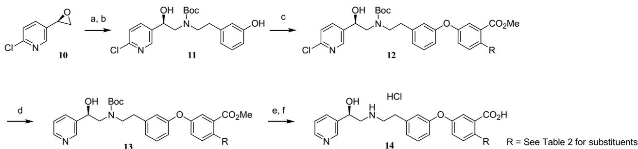
**Scheme 3.** Reagents: (a) 3-(2-aminoethyl)phenol, EtOH; (b)  $\text{Boc}_2\text{O}$ , THF; (c) boronic acid,  $\text{Cu}(\text{OAc})_2$ , pyridine, MS 4 Å,  $\text{CH}_2\text{Cl}_2$ ; (d)  $\text{HC}(\text{O})\text{NH}_4$ , Pd-C, MeOH,  $\text{H}_2\text{O}$ ; (e) 1 N NaOH aq, MeOH; (f) 4 N HCl in dioxane.
