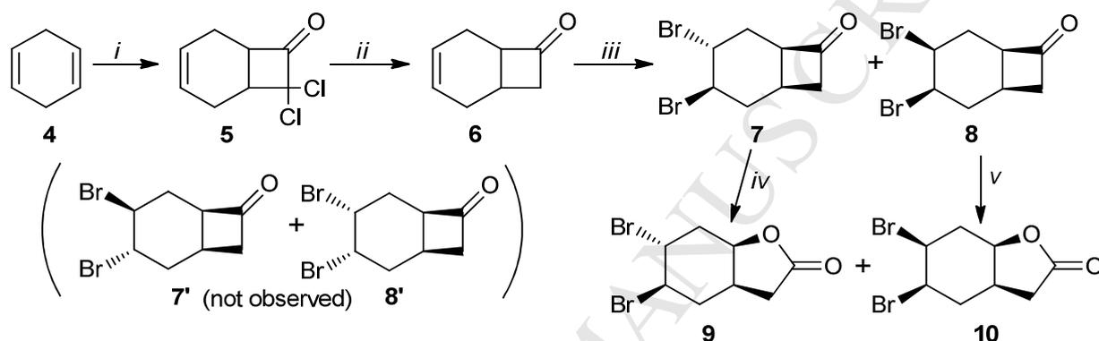
**Fig 2.** Reagents and conditions: (i)  $Cl_3CCOCl$ , Zn,  $POCl_3$ , ether,  $25\text{ }^\circ C$ , 87%; (ii) Zn,  $CH_3COOH$ , 92%; (iii)  $Br_2$ ,  $CHCl_3$ ,  $0\text{ }^\circ C$ , 60% *trans*, 30% *cis*; (iv)  $H_2O_2$ ,  $CH_2Cl_2$ , 85%, (v)  $H_2O_2$ ,  $CH_2Cl_2$ , r.t., 80% [17].
