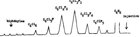
Fig. 4 - Chromatogramme (colonne SE 30) montrant la situation des molécules condensées.  ${\rm C_6Cl_6/KF}$  =0,102 mole  ${\rm C_6Cl_6}$  = 0,007 mole, T = 425°C, durée de la réaction = 19<sup>h</sup>. Vol. 41 cm<sup>2</sup>
