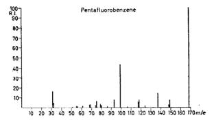
Fig. 7. Spectre trouvé pour C<sub>6</sub>F<sub>5</sub>H
