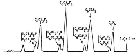
Fig. 1: chromatogramme (colonne SE 30, 4 m) obtenu avec  $C_6C1_6$ , KF et de l'eau ( $C_6C1_6$ /KF = 0,102 mole,  $C_6C1_6$ = 0,007 mole,  $T_6$ =6480°C, durée de la réaction = 19<sup>h</sup>, 2 gouttes d'eau;  $R_6$ =35%); 1 goutte d'eau  $\longrightarrow$  0,0028 mole d'eau;  $V_6$ =41 cm<sup>3</sup>.
