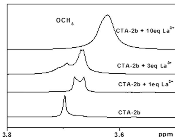
**Fig. 9.**  $^1\text{H}$  NMR spectra (methoxy) of **CTA-2b** upon titration with  $(\text{CF}_3\text{SO}_3)_3\text{La}$  ( $\text{DMSO}-d_6$ , 298 K).
