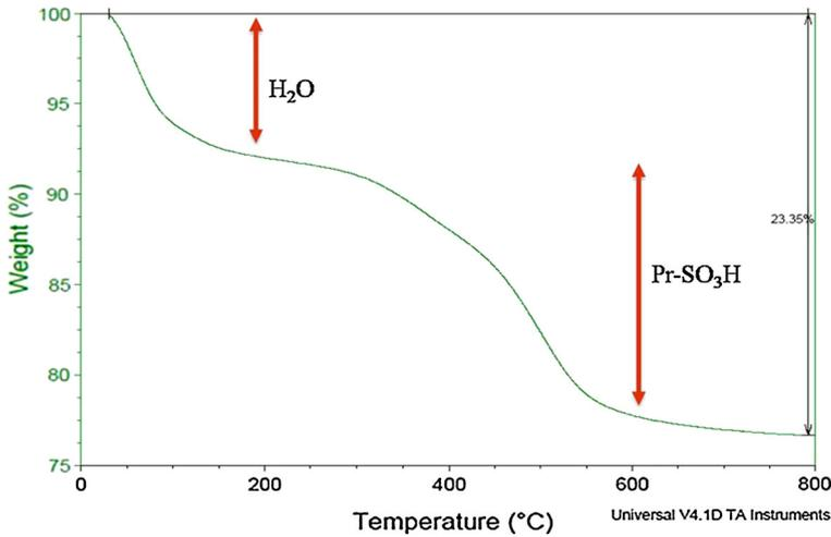
**Fig. 2** TGA diagram of LUS-Pr-SO<sub>3</sub>H
