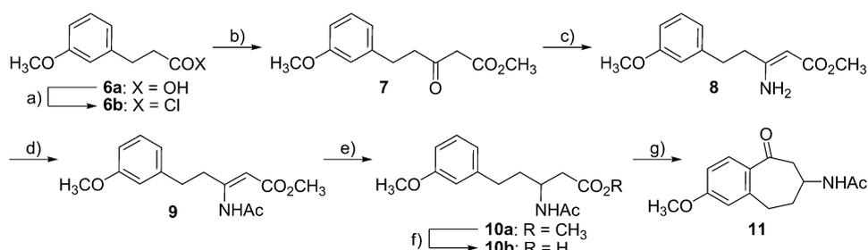
**Scheme 1.** Synthesis of benzo[7]annulen-5-one 11. Reagents and conditions: a) 1. oxalyl chloride,  $CH_2Cl_2$ , DMF, RT, 21 h, 94%; b) Meldrum's acid,  $CH_2Cl_2$ , pyridine, 0 °C, 30 min, RT, 1 h, then  $CH_3OH$ , reflux, 3 h, 71%; c)  $NH_4OAc$ ,  $CH_3OH$ , 35 °C, 16 h, 100%; d)  $Ac_2O$ , pyridine, THF, reflux, 48 h, 100%; e)  $H_2$  (5 bar), Pd/C,  $CH_3OH$ , RT, 48 h, 76%; f) KOH,  $CH_3OH$ , RT, 3 h, 93%; g)  $P_4O_{10}$ ,  $CH_3SO_3H$ ,  $CH_2Cl_2$ , -10 °C, 30 min, RT, 2 h, 65%.
