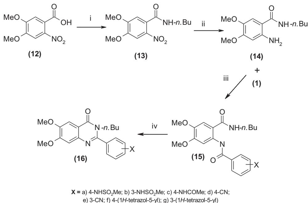
**Scheme 4.** Reagents and conditions: i) SOCl<sub>2</sub>, *n*-BuNH<sub>2</sub>, THF; ii) Fe, NH<sub>4</sub>Cl, CH<sub>3</sub>OH; iii) SOCl<sub>2</sub>, TEA, 1,4 Dioxane; iv) NaOH, CH<sub>3</sub>OH.
