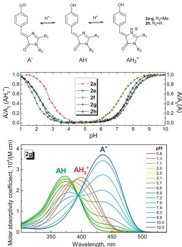
**Fig. 1** pH-titration of chromophores **2a–h**.
