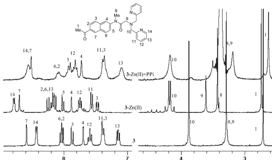
Fig. 13  $^1\text{H}$  NMR data of **3**, **3-Zn(II)**, **3-Zn(II)/PPI** (1 : 1 ratio), taken in  $\text{CD}_3\text{CN}$  ( $\text{D}_2\text{O}$  used for PPI).
