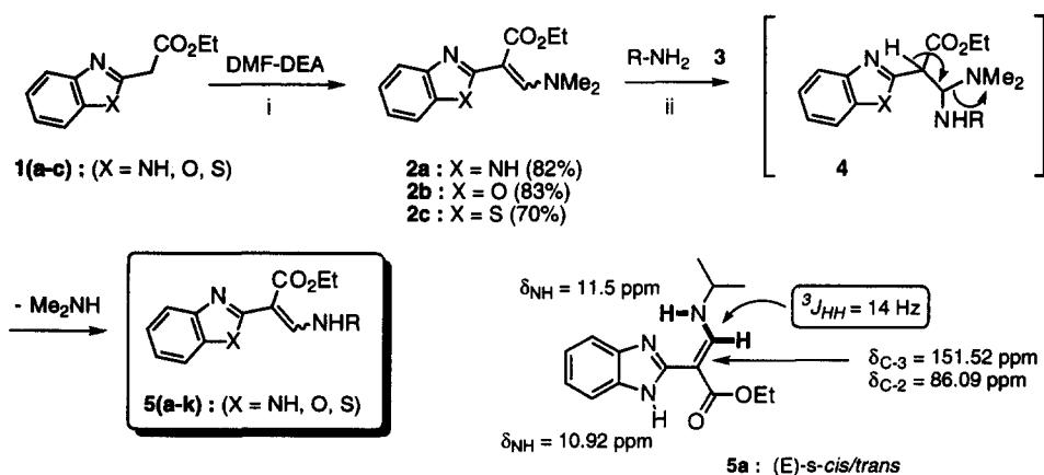
(i) :  $\mu\omega$  (Synthewave® 402 reactor), 90°C, 15 min. (ii) :  $\mu\omega$ , 30 min.
