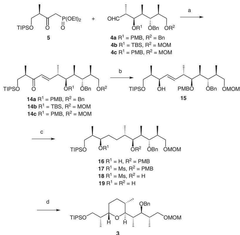
**Scheme 4** Reagents and conditions: (a)  $\text{Ba}(\text{OH})_2$ , THF– $\text{H}_2\text{O}$  (9:1), 1 h, 83%; (b) (*R*)-Me-CBS,  $\text{BH}_3 \cdot \text{SM}_2$ , anhydrous toluene, 0 °C, 1 h, 66%; (c) (i)  $\text{PtO}_2$ , EtOAc, 3 h, r.t., 90%; (ii) DDQ,  $\text{CH}_2\text{Cl}_2$ – $\text{H}_2\text{O}$  (9:1), 1 h, 0 °C to r.t., 50%; (d) DEAD,  $\text{Ph}_3\text{P}$ , toluene, 0 °C to r.t., 12 h, 37%.
