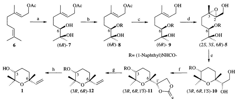
Scheme 2. (a) AD-mix- $\beta$ ; (b) (1-naphthyl)NCO; (c)  $K_2CO_3$ , MeOH; (d) L-(+)-DET,  $Ti(O-i-Pr)_4$ , *t*-BuOOH; (e) cat. 10-camphor-sulfonic acid; (f) 1,1'-thiocarbonyldiimidazole; (g)  $P(OMe)_3$ , reflux; (h) 10% MeONa, MeOH, reflux
