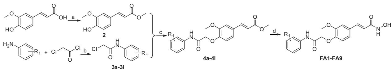
Scheme 1. Preparation of compounds **FA1–FA9**. Reagents and conditions: (a)  $CH_3OH$ ,  $H_2SO_4$ ; (b)  $CH_2Cl_2$ ,  $Et_3N$ ; (c)  $K_2CO_3$ , acetone; (d)  $NH_2OK$ ,  $NH_2OH$ ,  $DMF$ .
