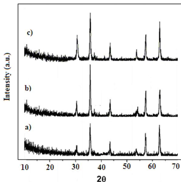
**Fig. (1).** XRD pattern of the a) (Fe<sub>3</sub>O<sub>4</sub>-DA-Phe), b) (Fe<sub>3</sub>O<sub>4</sub>-DA-Val) and c) (Fe<sub>3</sub>O<sub>4</sub>-DA-Ile)).
