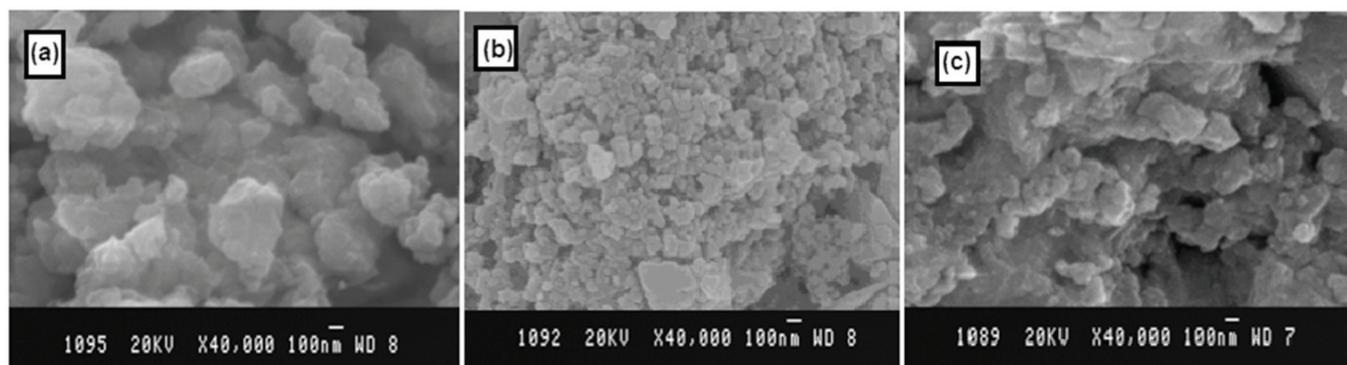
**Fig (2).** SEM images of synthesized a) ( $\text{Fe}_3\text{O}_4\text{-DA-Phe}$ ), b) ( $\text{Fe}_3\text{O}_4\text{-DA-Val}$ ) and c) ( $\text{Fe}_3\text{O}_4\text{-DA-Ile}$ ).
