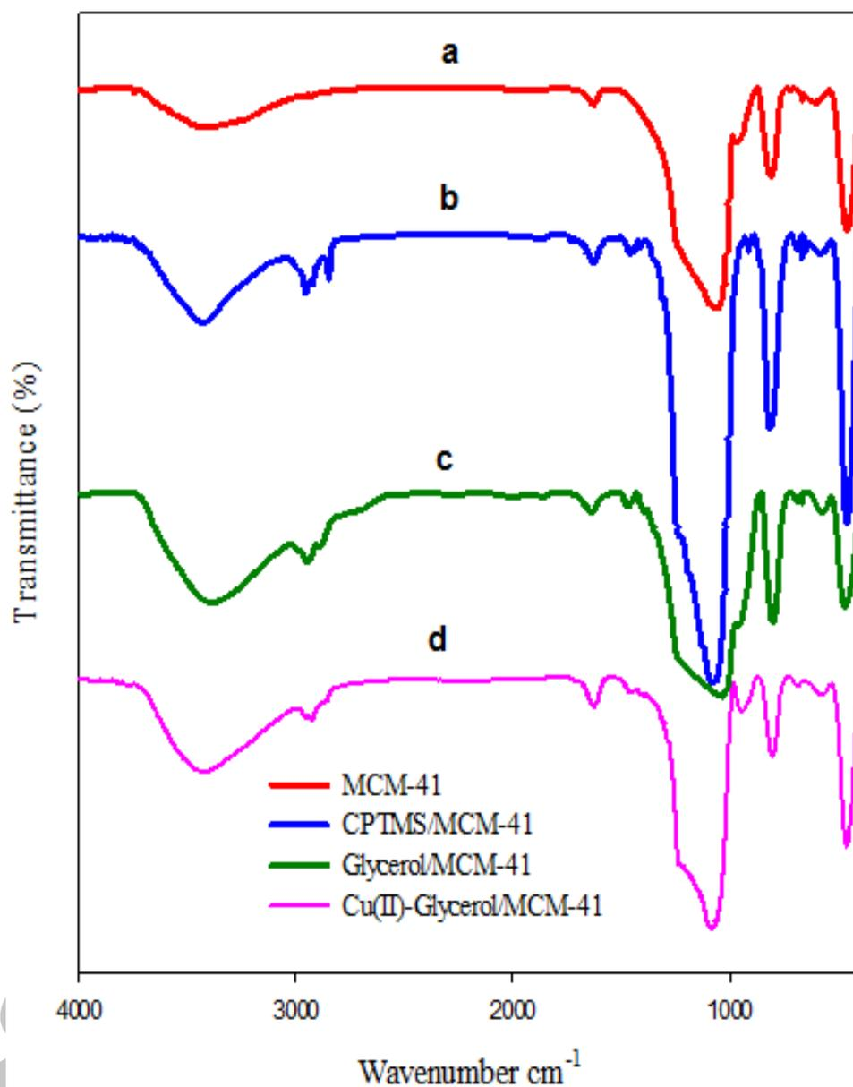
**Figure 2.** FT-IR spectra of, (a) MCM-41, (b) CPTMS/MCM-41, (c) Glycerol/MCM-41 and (d) Cu(II)-Glycerol/MCM-41
