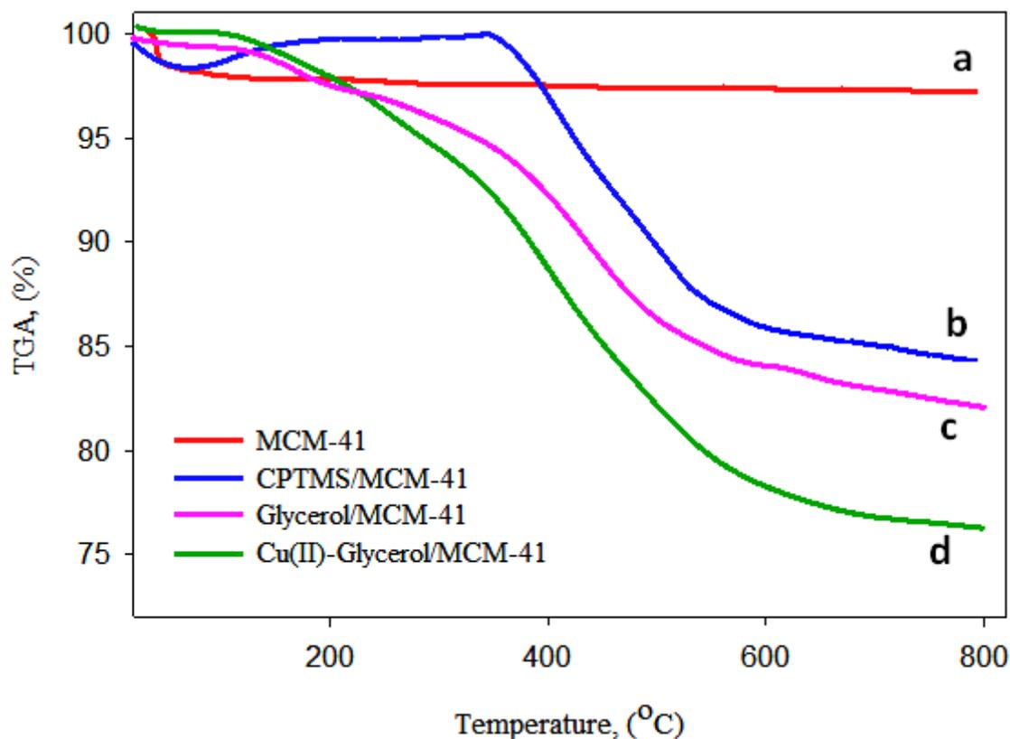
**Figure 6.** TGA thermograms of (a) MCM-41, (b) CPTMS/MCM-41, (c) Glycerol/MCM-41 and (d) Cu(II)-Glycerol/MCM-41
