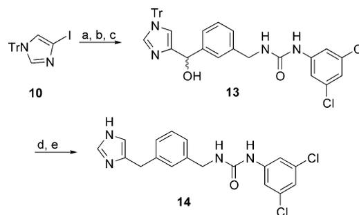
**Scheme 5.** (a) EtMgBr,  $CH_2Cl_2$ , 4-NCC $_6H_4CHO$ , 66%; (b)  $H_2$ , Ra-Ni,  $NH_3$ /MeOH, 99%; (c) 3,5- $Cl_2C_6H_4NCO$ , THF, 50%; (d) NaI,  $Me_2SiCl_2$ , acetone/ $CH_2Cl_2$ , 54%; (e) maleic acid, MeOH/ $CH_2Cl_2$ , 92%.
