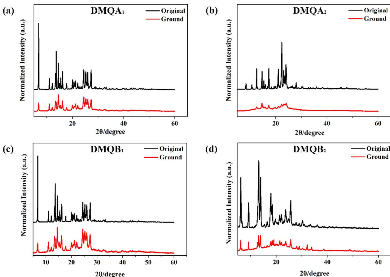
Fig. 6. XRD patterns of the original and grounded samples. (a)  $DMQA_1$ ; (b)  $DMQA_2$ ; (c)  $DMQB_1$  and (d)  $DMQB_2$ .
