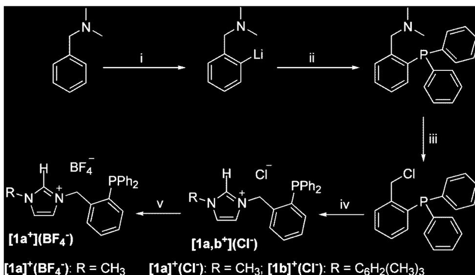
**Scheme 1.** i) 1.2 equiv. *n*-BuLi, Et<sub>2</sub>O, r.t., 14 h, ii) 1.2 equiv. Ph<sub>2</sub>PCl, Et<sub>2</sub>O, -78 °C - r.t., 2 h, iii) 1.3 equiv. ClCO<sub>2</sub>Et, benzene, refl., 2 h, iv) 1.0 equiv. *N*-substituted imidazole, MeCN, refl., 18 h, v) 1.2 equiv. NaBF<sub>4</sub>, CH<sub>2</sub>Cl<sub>2</sub>, 18 h, r.t..
