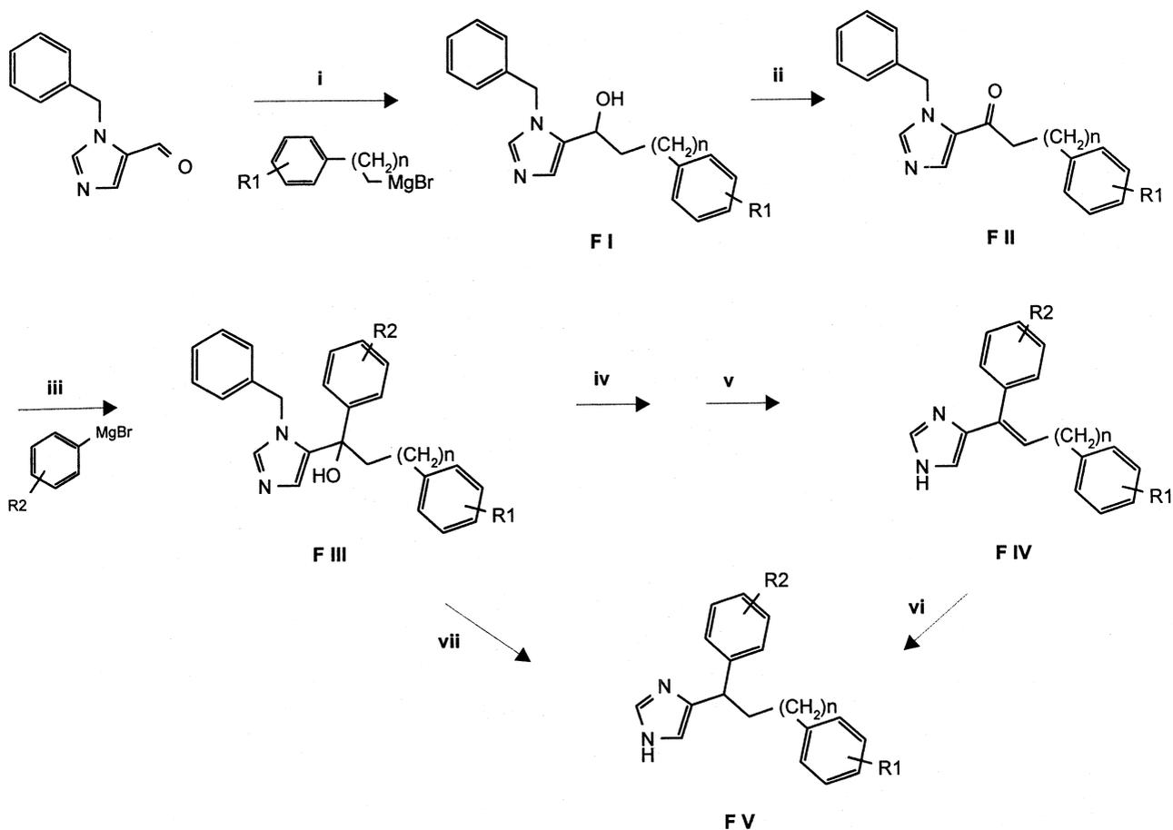
i: THF; ii: MnO<sub>2</sub>, C<sub>2</sub>Cl<sub>4</sub>; iii: THF; iv: H<sub>2</sub>, Pd/C, H<sup>+</sup>, ethanol, RT; v: HCl, ethanol; vi: Pd/C, ethanol, RT; vii: HCOONH<sub>4</sub>, Pd/C, CH<sub>3</sub>COOH, refl.
