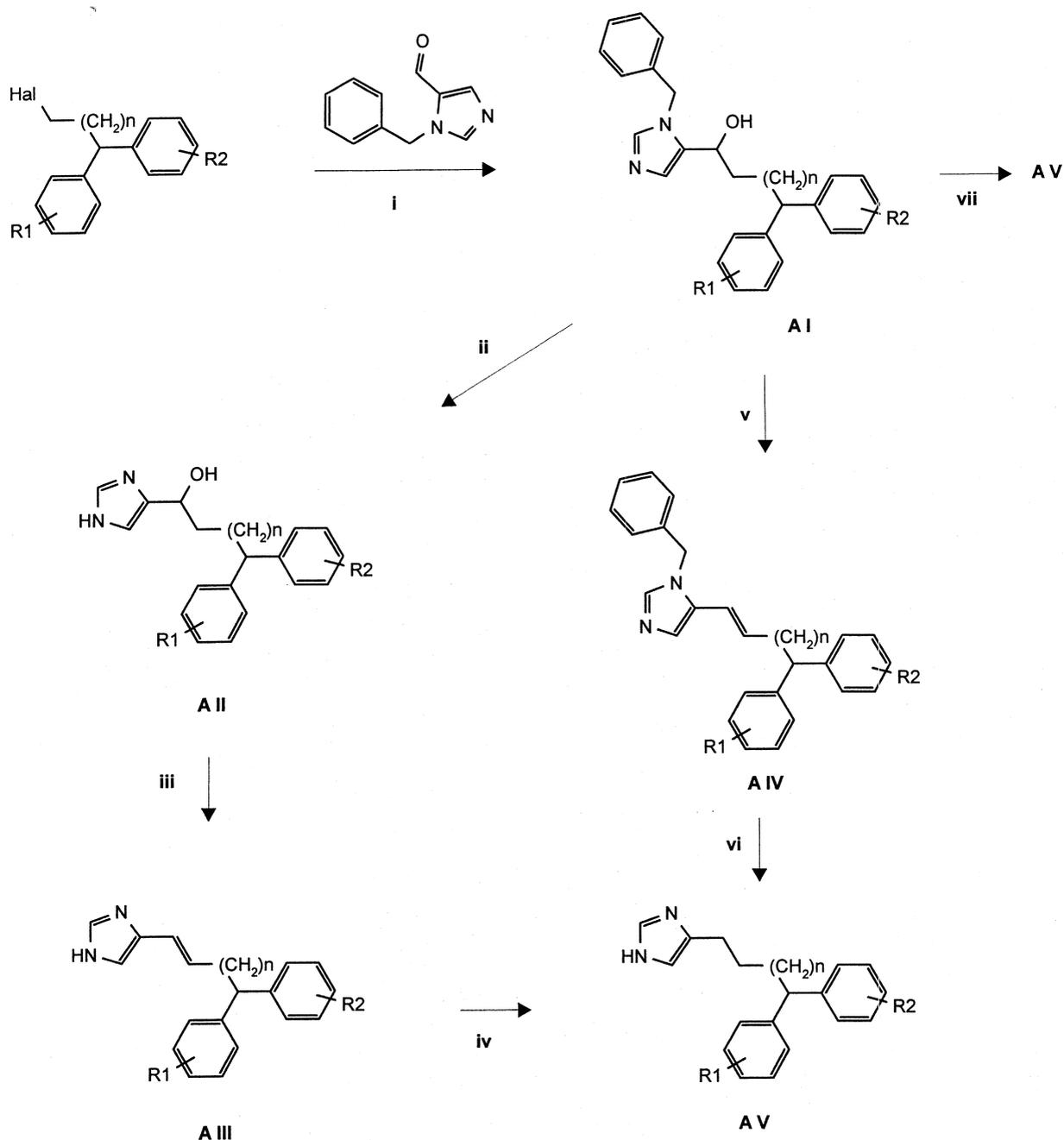
i: Mg, THF; ii: HCOONH<sub>4</sub>, Pd/C, ethanol, refl. or H<sub>2</sub>, Pd/C, ethyl acetate, RT; iii: K<sub>2</sub>SO<sub>4</sub> or conc. HCl; iv: H<sub>2</sub>, Pd/C, ethanol; v: H<sup>+</sup>; vi: H<sub>2</sub>, Pd/C, H<sup>+</sup>, ethanol; vii: HCOONH<sub>4</sub>, Pd/C, CH<sub>3</sub>COOH, refl.
