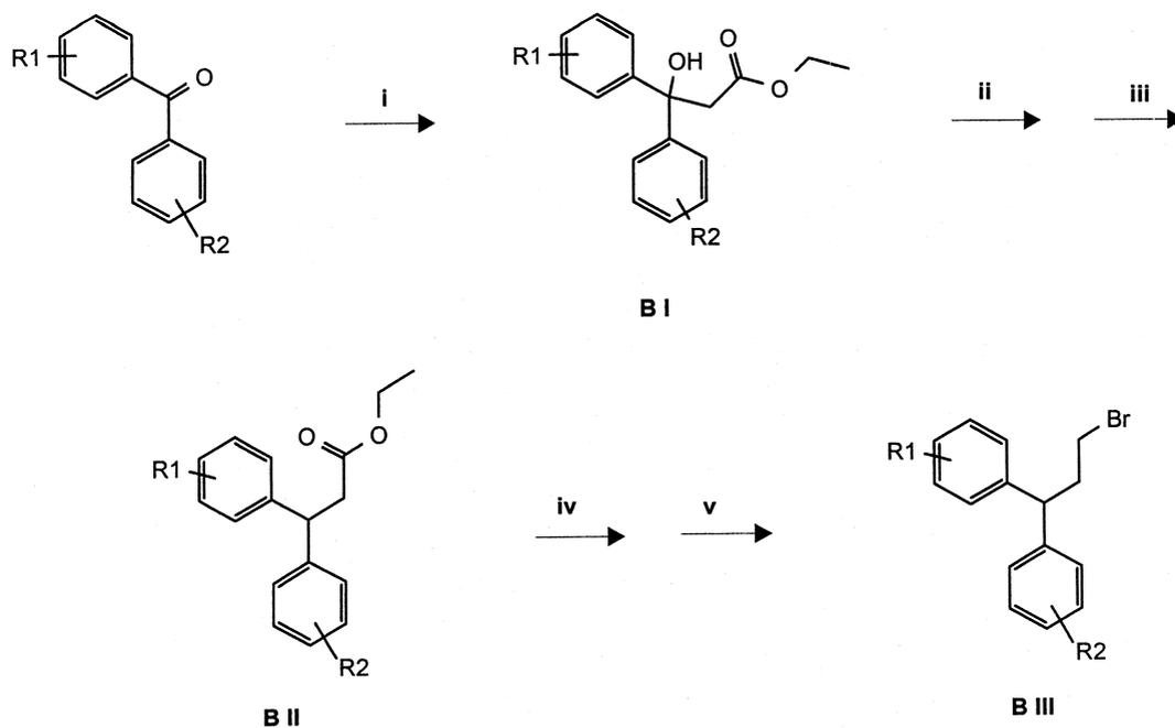
i:  $\text{BrCH}_2\text{COOEt}$ , Zn; ii:  $\text{-H}_2\text{O}$ ; iii:  $\text{H}_2$ , Pd/C, ethanol; iv:  $\text{LiAlH}_4$ , THF; v:  $\text{HBr}$
