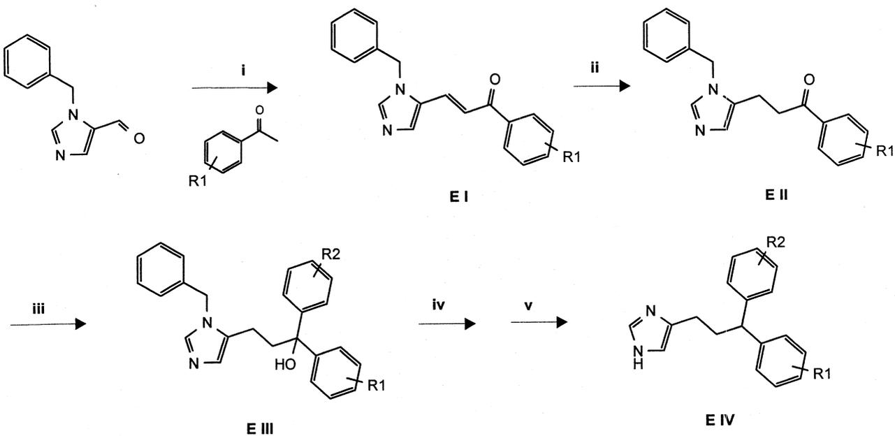
i: OH<sup>-</sup>, EtOH or MeOH; ii:  $\text{H}_2$ , Pd/C, ethanol; iii:  $\text{R}_2\text{PhMgBr}$ , THF; iv: HCl, ethanol; v:  $\text{H}_2$ , Pd/C,  $\text{H}^+$ , ethanol
