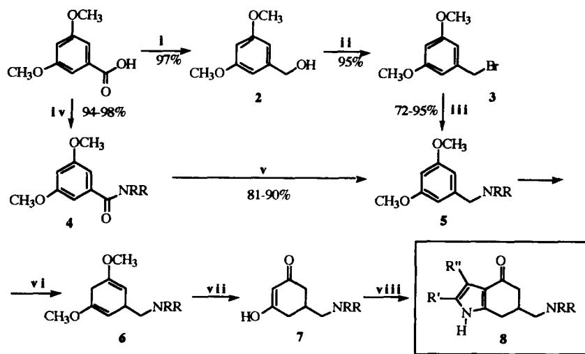
Reagents: i: LiAlH<sub>4</sub>, THF, r.t., 12 h; ii: CBr<sub>4</sub>, Ph<sub>3</sub>P, CH<sub>2</sub>Cl<sub>2</sub>, r.t., 24 h; iii: HNRR, Na<sub>2</sub>CO<sub>3</sub>, IK, MIK, reflux, 20 h; iv: HNRR, DCC, HOBT, CH<sub>2</sub>Cl<sub>2</sub>, r.t., 6 h; v: LiAlH<sub>4</sub>, THF, r.t., 12 h; vi: Li, NH<sub>3</sub>, MeOH, t-BuOH, -40°C, 2 h; vii: HCl, THF, r.t., 3 h; viii: R'CONHCOR'', Zn, AcOH 70%, reflux, 4 h.
