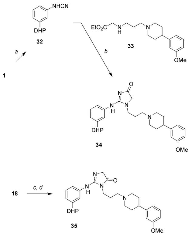
**Scheme 8.** Synthesis of imidazolones **34** and **35**: (a)  $\text{NaHCO}_3$ ,  $\text{BrCN}$ ,  $\text{EtOH}$  (100%); (b)  $\text{Na}_2\text{CO}_3$ ,  $\text{MeCN}$  (3%); (c) **3a**,  $\text{Na}$ ,  $\text{EtOH}$ ; (d) ethyl glycinate,  $\text{HgCl}_2$ ,  $\text{THF}$  (5%).
