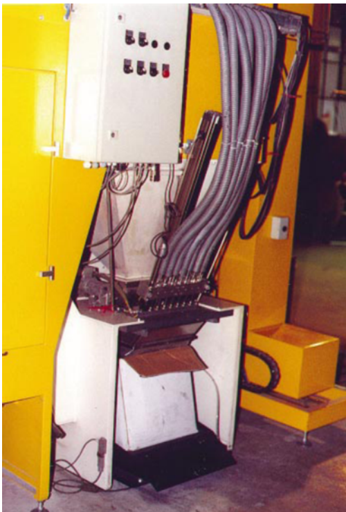
Das Pulverzentrum ist platzsparend unter dem Multizyklon integriert
