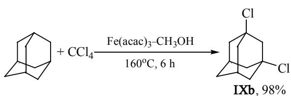
$\text{Fe}(\text{acac})_3\text{-AdH-CCl}_4\text{-CH}_3\text{OH}$ , 0.03 : 1 : 2 : 1.
