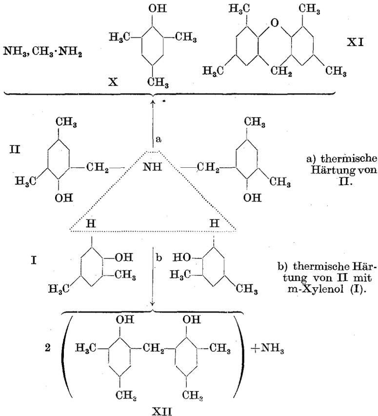
Erhitzt man die Verbindung II mit m-Xylenol (0,01 : 0,02 Mol) allmählich auf  $280^\circ$ , so spaltet sich Ammoniak ab. Das Reaktionsprodukt erstarrt nach 24stündigem Stehen zu einer gelben kristallinen Masse. Durch Umfällen aus wäßriger, alkalischer Lösung mit verdünnter Salzsäure, Umkristallisieren aus verdünntem Alkohol und Sublimieren ge-
