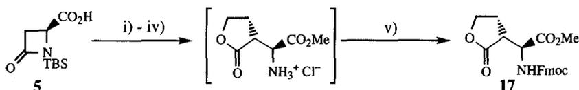
i) LDA (2.2 equivalents), THF,  $0^\circ\text{C} \rightarrow -78^\circ\text{C}$ ; ii) **11**, THF,  $-78^\circ\text{C} \rightarrow \text{r.t.}$ ;
