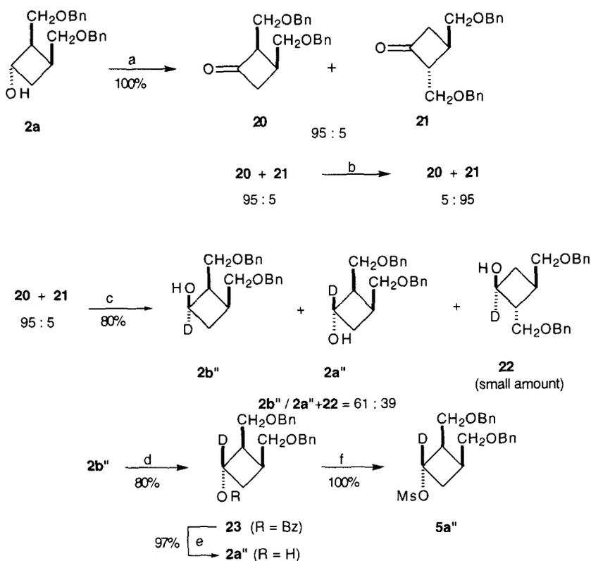
(a)  $(\text{COCl})_2$ , DMSO,  $\text{Et}_3\text{N}$ ,  $\text{CH}_2\text{Cl}_2$ ,  $-78^\circ\text{C} \rightarrow \text{r.t.}$ ; (b) chromatography on silica gel; (c)  $\text{NaBD}_4$ , EtOH, 25 min, r.t.; (d)  $\text{PPh}_3$ , DEAD, PhCOOH, THF,  $0^\circ\text{C}$  then 6 days, r.t.; (e) 15% NaOH, MeOH, 17h, r.t.; (f) MsCl,  $\text{Et}_3\text{N}$ ,  $\text{CH}_2\text{Cl}_2$ ,  $0^\circ\text{C}$ .
