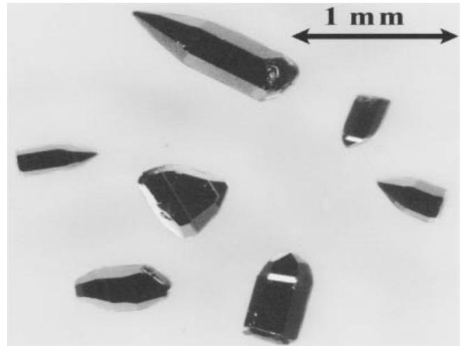
**Abb. 3** Typische Kristalle von  $\text{Co}_{2-x}\text{Zn}_x\text{Mo}_3\text{O}_8$ , Transportmittel  $\text{NH}_4\text{Br}$ **Tabelle 2** Chemischer Transport von  $\text{Co}_{2-x}\text{Zn}_x\text{Mo}_3\text{O}_8$ : Vergleich der Co-Gehalte  $x$  bei  $T_2$  (Ausgangsbodenkörper) und  $T_1$  (abgeschiedene Kristalle, ESMA/EDX-Messungen)
