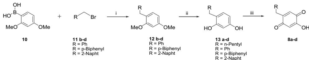
**Scheme 2.** Reagents and conditions: (i)  $K_3PO_4$ ,  $Pd(OAc)_2$ ,  $PPh_3$ , toluene,  $110^\circ C$ , 16 h; (ii)  $BBr_3$ ,  $CH_2Cl_2$ ,  $-15^\circ C$  to rt, 18 h; (iii)  $NO(KSO_3)_2$ ,  $Na_2CO_3$ , THF– $H_2O$ , rt, 10 h.
