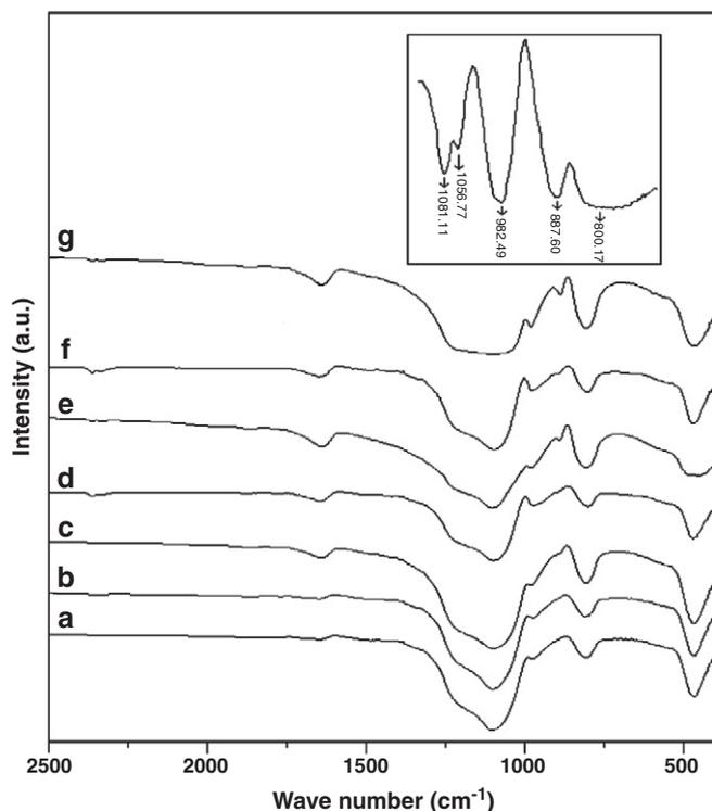
Fig. 1. FT-IR spectra of SiO $_2$ , TPAV $_1$  and TPAV $_1$ /SiO $_2$  catalysts. (a) SiO $_2$  (b) 5 wt.% TPAV $_1$ /SiO $_2$  (c) 8 wt.% TPAV $_1$ /SiO $_2$  (d) 10 wt.% TPAV $_1$ /SiO $_2$  (e) 12 wt.% TPAV $_1$ /SiO $_2$  (f) 15 wt.% TPAV $_1$ /SiO $_2$  (g) 20 wt.% TPAV $_1$ /SiO $_2$ .
