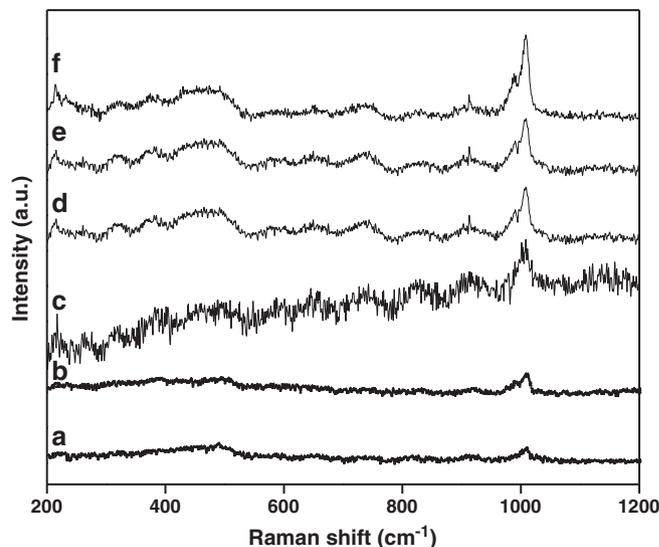
Fig. 2. Laser-Raman spectra of TPAV $_1$ /SiO $_2$  catalysts. (a) 5 wt.% TPAV $_1$ /SiO $_2$  (b) 8 wt.% TPAV $_1$ /SiO $_2$  (c) 10 wt.% TPAV $_1$ /SiO $_2$  (d) 12 wt.% TPAV $_1$ /SiO $_2$  (e) 15 wt.% TPAV $_1$ /SiO $_2$  (f) 20 wt.% TPAV $_1$ /SiO $_2$ .
