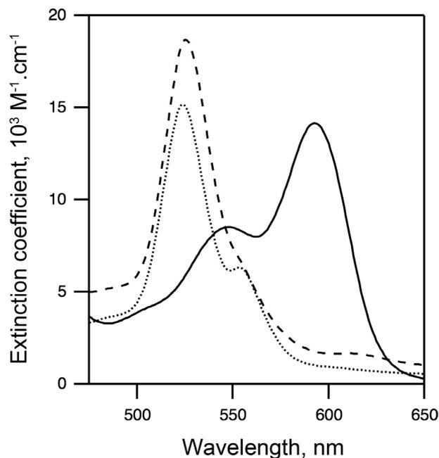
**Fig. 2.** The UV-visible spectra of NiDAPCHO (**Ni4a**, solid), NiDAPCH $_3$  (**Ni4b**, dashed), and NiDAPCH $_2\text{OH}$  (**Ni4d**, dotted)
