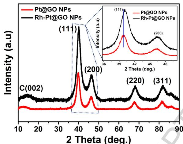
**Fig. 1.** XRD pattern of Rh-Pt@GO NPs
