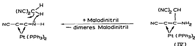
Die instabile Zwischenstufe (IV) konnte direkt aus  $(\text{Ph}_3\text{P})_2\text{PtC}_2\text{H}_4$  und (I) isoliert werden. Die Koordination von (IV) in der Enamin-Form wird durch die beiden  $\nu(\text{NH})$ -Banden bei  $3322$  und  $3185\text{ cm}^{-1}$  gestützt.
