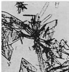
Gemisch von 1,3- und 1,7-Sulfochlorid, rechts im polarisierten Licht: bei den senkrecht aufeinanderstehenden Krystallen sind die verschiedenen Auslöschungsrichtungen der beiden Isomeren deutlich erkennbar
