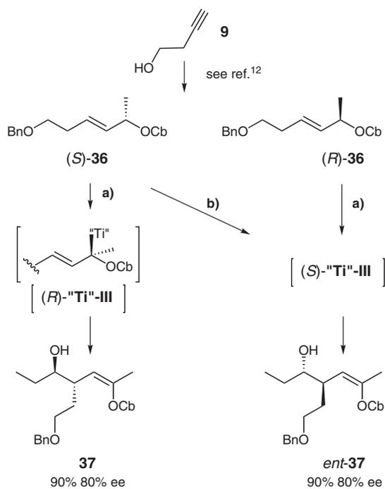
**Scheme 10** Reagents and conditions: **a**) *n*-BuLi/TMEDA, toluene,  $-78^\circ\text{C}$ , 1 h,  $\text{Ti}(\text{O}i\text{-Pr})_4$ ,  $-78^\circ\text{C}$ , 20 min, propanal  $-78^\circ\text{C}$ , 2 h; **b**) *n*-BuLi/(–)sparteine, toluene,  $-78^\circ\text{C}$ , 1 h,  $\text{Ti}(\text{O}i\text{-Pr})_4$ ,  $-78^\circ\text{C}$ , 20 min, propanal  $-78^\circ\text{C}$ , 2 h.
