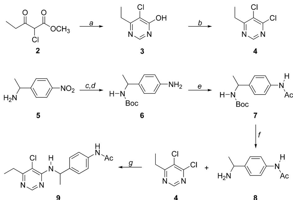
**Scheme 1.** Synthesis of benzylaminopyrimidine **9**. Reagents and conditions: (a)  $H_2NCH=NH\cdot HCl$ ,  $CH_3ONa$ , MeOH; (b)  $POCl_3$ , toluene, 77%; (c)  $BOC_2O$ ,  $NaHCO_3$ ,  $CH_2Cl_2/H_2O$ , 25 °C, 12 h, 92%; (d) Ni,  $H_2$ ,  $N_2H_4$ , EtOH, 25 °C, 24 h, 50%; (e)  $Ac_2O$ , Py, DMAP,  $CH_2Cl_2$ , 0–25 °C, 3 h, 88%; (f)  $CF_3COOH$ ,  $CH_2Cl_2$ , 25 °C, 3 h, 88%; (g) **4**, DMF,  $K_2CO_3$ , 80 °C, 5 h, 45%.
