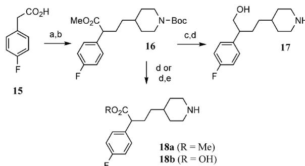
**Scheme 5.** (a)  $\text{TMSCHN}_2$ ,  $\text{MeOH}$ , THF; (b)  $\text{NaH}$ , iodide **7**,  $\text{DMF}$ ; (c)  $\text{LiBH}_4$ , THF; (d)  $\text{HCl}$ ,  $\text{MeOH}$ ; (e) 1 N  $\text{NaOH}$ ,  $\text{MeOH}$ .
