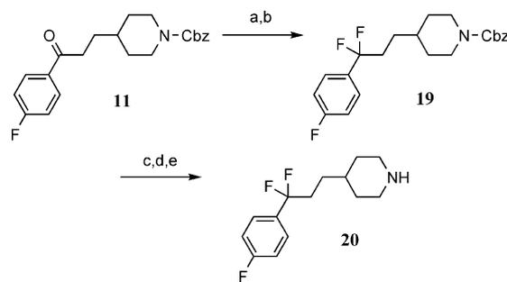
**Scheme 6.** (a) 1,2-Ethanedithiol,  $\text{BF}_3 \cdot 2\text{HOAc}$ ,  $\text{CH}_2\text{Cl}_2$ ; (b) 1,3-dibromo-5,5-dimethylhydantoin,  $\text{HF-pyr}$ ,  $\text{CH}_2\text{Cl}_2$ ,  $-78^\circ\text{C}$ ; (c)  $\text{H}_2$ ,  $\text{Pd}(\text{OH})_2/\text{C}$ , 95%  $\text{EtOH}$ ; (d)  $\text{Boc}_2\text{O}$ ,  $\text{CH}_2\text{Cl}_2$ ; (e) TFA,  $\text{CH}_2\text{Cl}_2$ .
