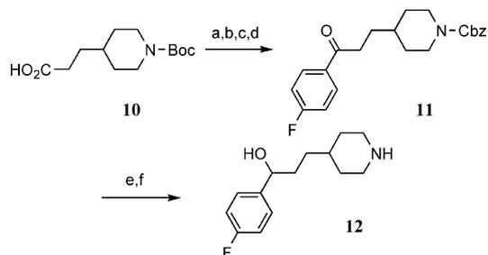
**Scheme 3.** (a)  $\text{NMM}$ ,  $i\text{BuOCOCl}$ ,  $\text{CH}_2\text{Cl}_2$ ,  $0^\circ\text{C}$ ;  $\text{NMM}$ ,  $\text{MeONH-Me-HCl}$ ; (b) 4-F-phenyl-MgBr, THF,  $\text{Et}_2\text{O}$ ,  $0^\circ\text{C}$ ; (c) TFA,  $\text{CH}_2\text{Cl}_2$ ; (d)  $\text{Cbz-Cl}$ ,  $\text{NaOH}$ , THF; (e)  $\text{NaBH}_4$ , THF; (f)  $\text{H}_2$ ,  $\text{Pd/C}$ ,  $\text{MeOH}$ .
