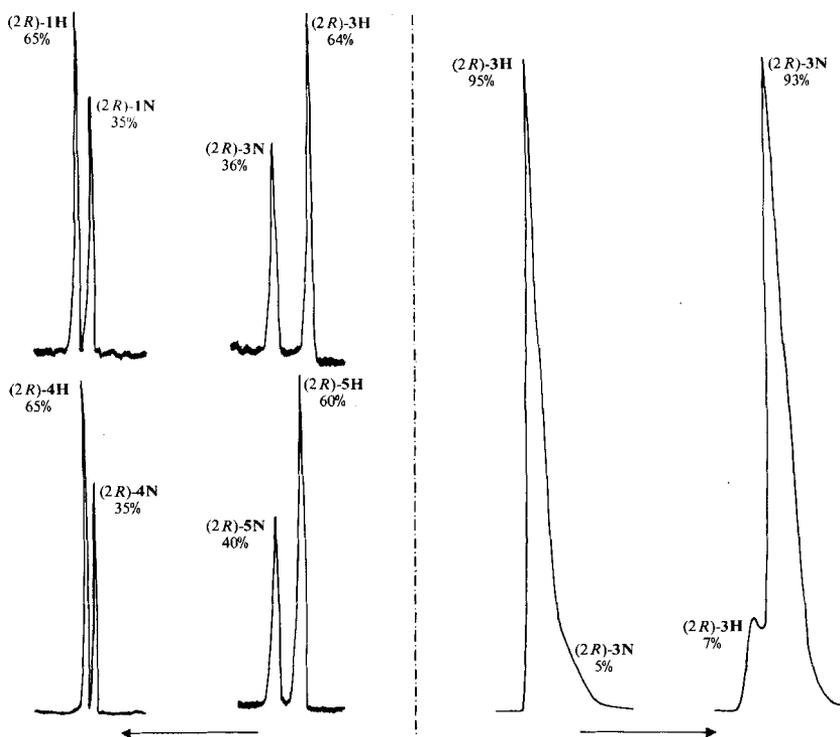
Figur. Links: Kapillar-GC. (20 m x 0,38 mm, Apiezon L) der Verbindungen 1, 3, 4 und 5; rechts: GC. (3 m x 2 mm, Apiezon L, Säulentemp. 100°) der getrennten Diastereomeren H (Hauptkomponente) und N (Nebenkompente) von (2R)-3. (->: zunehmende Retentionszeiten.)
