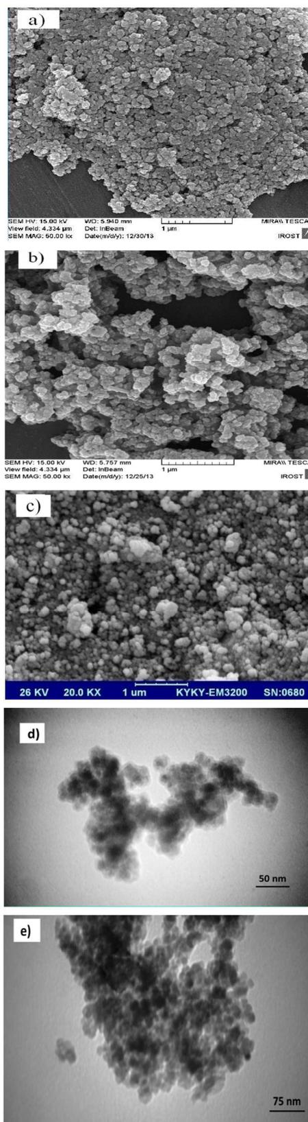
**Figure 3.** SEM image of the a)  $\text{Fe}_3\text{O}_4$ , b)  $\text{Fe}_3\text{O}_4@SiO_2$  and c)  $\text{Fe}_3\text{O}_4@SiO_2-TiO_2$ . TEM image of the d)  $\text{Fe}_3\text{O}_4@SiO_2$  and e)  $\text{Fe}_3\text{O}_4@SiO_2-TiO_2$ .
