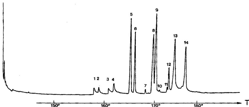
Die 14 in der Figur erscheinenden Substanzen wurden beim Anschluss der Glaskapillare an ein niederauflösendes Massenspektrometer als folgende Mono- Di- und Trisilylderivate identifiziert:
