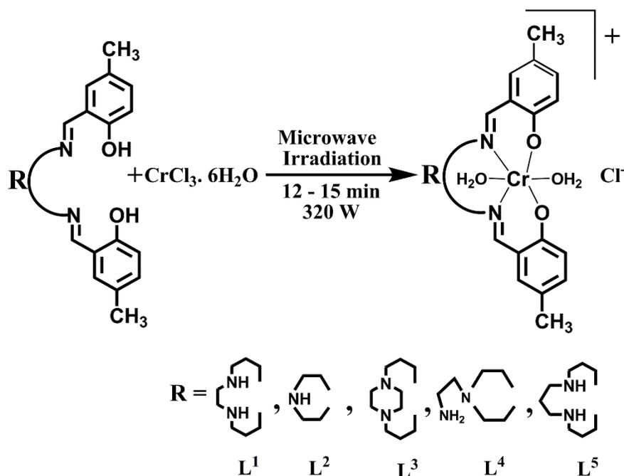
**Scheme-2: Synthesis of chromium Schiff base complexes.**
