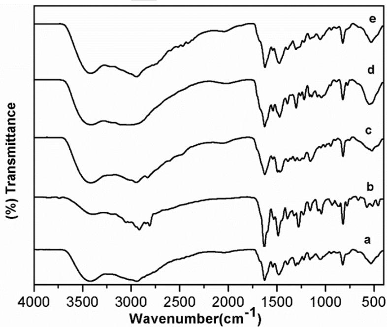
**Fig-1(B):** FT-IR spectra of chromium Schiff base complexes (a)  $[CrL^1(H_2O)_2]^+$ ; (b)  $[CrL^2(H_2O)_2]^+$ ; (c)  $[CrL^3(H_2O)_2]^+$ ; (d)  $[CrL^4(H_2O)_2]^+$ ; (e)  $[CrL^5(H_2O)_2]^+$ .
