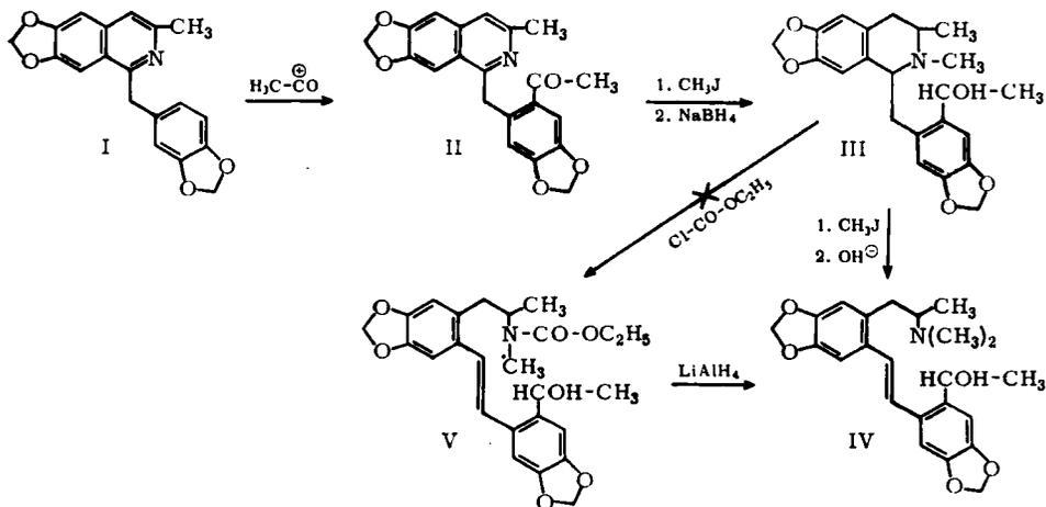
Ein Hofmann-Abbau nach erschöpfender Methylierung (III  $\rightarrow$  IV) sollte vermieden werden, da möglicherweise ein Gemisch der Isomere IV, IVa und IVb entstünde und zu trennen wäre, aber nur 1 g II zur Verfügung stand.
